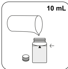
24-mm-Küvette mit 10 mL Probe füllen.
