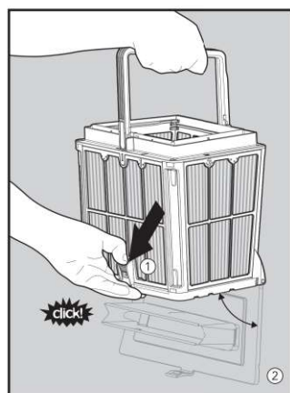
8.1.4 Otwórz dolną pokrywę kosza (2) używając zatrzasku pokrywy (1).
